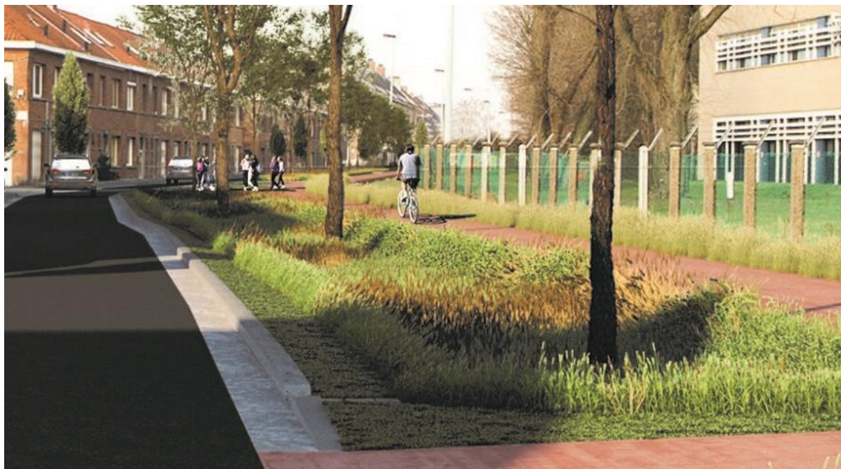
Figuur 26. Voorbeeld van een wadi uit het project Cluster Steenakker Gent. Bron: Blauwgroen Vlaanderen.
