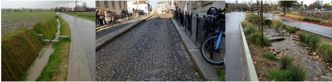
Figuur 21. Vlnr: (1) Gracht met bufferschotten. © Kruisem; (2) Verhoogde borduren van voetpaden in Parijs; (3) Doorvoer waterloop in groenberm straat. © svrdesign.com.
