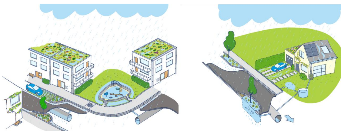
Figuur 11. Opvang en vertraagd afvoeren van hemelwater bij een norm neerslag © Aquafin.
