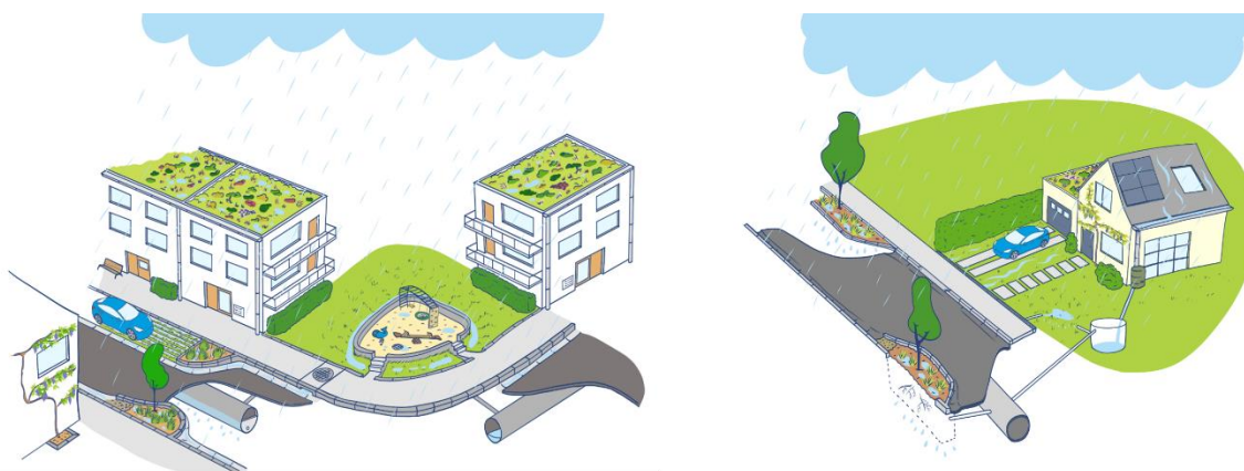
Figuur 10. Opvang en infiltratie van hemelwater bij frequente neerslag © Aquafin.
